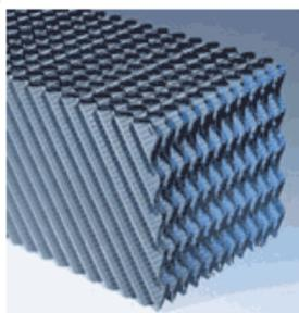
**IL RIEMPIMENTO SINTETICO D13** (come superficie di scambio nelle torri evaporative o di supporto per biomasse) è costituito da una serie di fogli termoformati in PVC di alta qualità, che vengono assemblati con la sagoma invertita ogni due fogli ed incollati per formare dei moduli con dimensioni riportate nella scheda tecnica.
