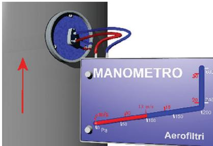
La Sonda K-flow viene posizionata in un punto opportuno del condotto mediante due Flange fissate al condotto. La Sonda viene inserita nel canale attraverso le feritoie delle due ghiera. L'inclinazione dell'asse della Sonda rispetto a quello del condotto si rende necessaria in caso di turbolenze del flusso che rendono instabile il segnale. Mediante un Manometro differenziale viene determinata la posizione di minore instabilità.
